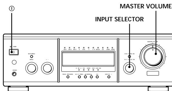
**1** Appuyez sur ① pour mettre l'amplificateur de contrôle sous tension.
