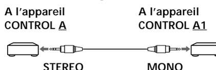
Veillez à raccorder la minifiche STEREO à l'appareil CONTROL A et la minifiche MONO à l'appareil CONTROL A1.
